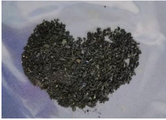
图 11 试验后掉落的碎屑
