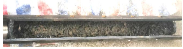
图 13 射孔后的射孔枪 1/3 剖开图
