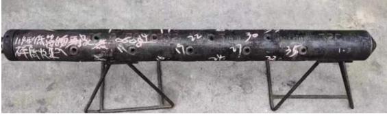
图 10 起爆后的射孔枪
