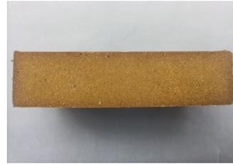
图 10 含降速剂 T8 的 NEPE 推进剂样品照片
