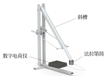
图 1 斜槽法测试实验装置
