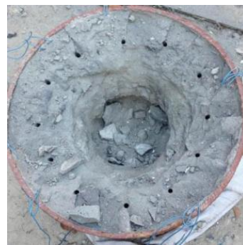
图7 孔内分段掏槽爆破后效果
