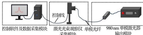
图 5 光学测试系统示意图
