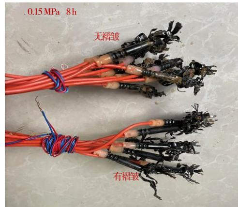
图3 电子雷管正常起爆后状态
