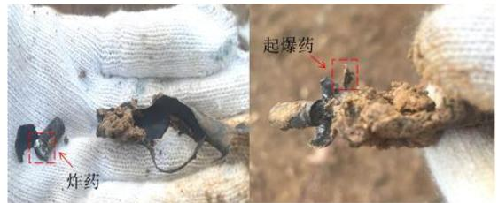
图4 电子雷管半爆后状态
