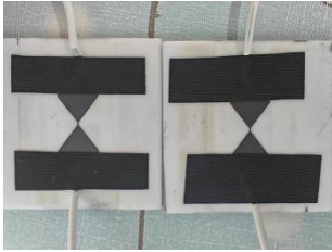
图4 试验所用碳基桥箔
