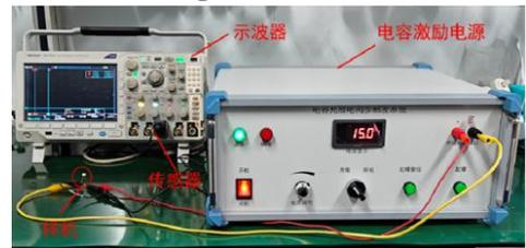
图 3 能量转换效率测试系统
