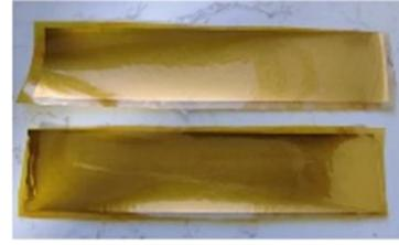
图1 贴膜式Ni-Cr薄膜
