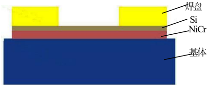
图 1 薄膜换能元整体结构设计示意图
