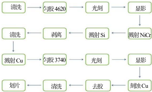
图 2 \text{NiCrSi} 薄膜换能元工艺流程图
