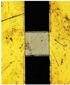
图 3 \text{NiCr}_{0.2}\text{Si}_{0.1} 薄膜换能元实物图
