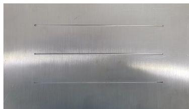
图 2 燃烧速度测试模具
