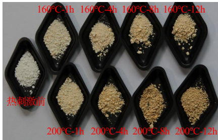
图1 HMX-F2604微球热刺激前后颜色变化情况
