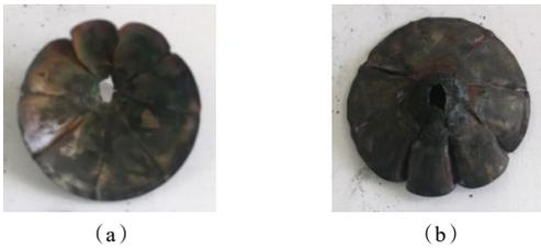
图5 故障产品拆解膜片照片
