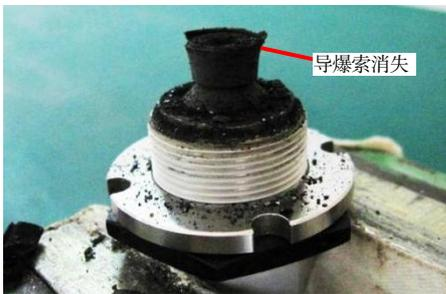
图 6 Φ3.85mm×6.50mm 雷管起爆导爆索试验后实物照片
