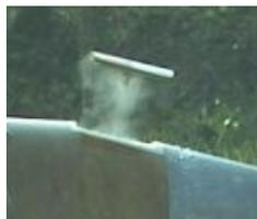
图 2 某火工分离装置试验中烟雾泄漏照片
