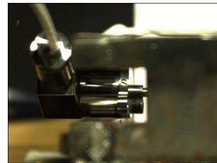
图6 火工分离装置高速摄影照片
