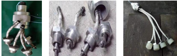
图2 接口连接强度试验残骸照片
