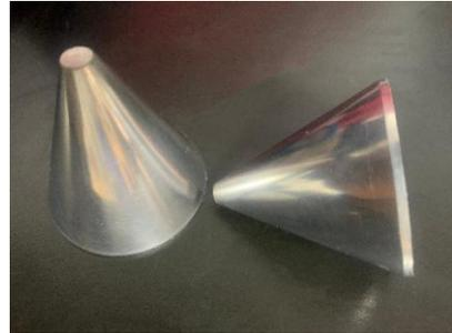
图 1 Cu-Ni-Al 反应药型罩
