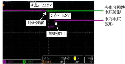
图 4 电容和集成电路受冲击电压波形
