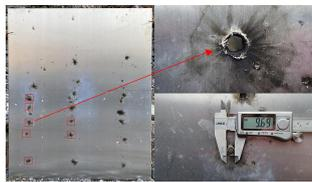
图4 含能微弹丸对铝板的毁伤效果（正面）
