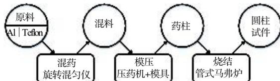
图 1 试件制备的工艺流程图
