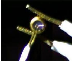
图 10 脚-壳静电放电产生的电弧
