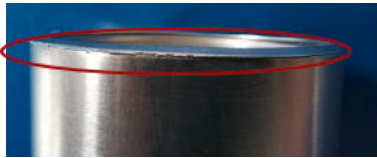
图 2 收口裂纹部位
