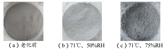
图 2 镁基贮氢合金 ABM-2 老化 56d 前后形貌图
