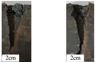
图 3 W-Ni-Al 反应射流侵彻 45# 钢 Fig.3 W-Ni-Al reaction jet penetrating 45# steel
