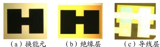
(a) 换能元 (b) 绝缘层 (c) 导线层
