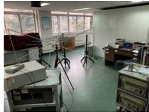
图 3 电磁环境模拟测试系统
