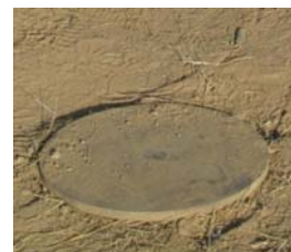
(a) 自由场压力传感器 (b) 地面压力传感器 图 1 压力传感器
