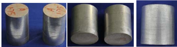
图 5 A-IX-II (Φ60 mm×60 mm) 裂纹观测照片
