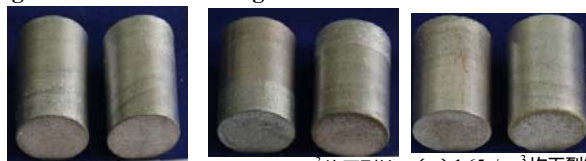
图 6 A-IX-II (Φ40 mm×40 mm) 裂纹观测照片
