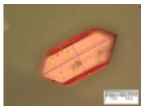
图 1 CuNT 的数码显微镜照片 (放大 2 \times 10^3 倍)
