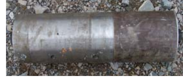
图 3 发动机舱 1 : 3 配重等效靶照片 Fig.3 Photo of the 1 : 3 equivalent target of the engine
