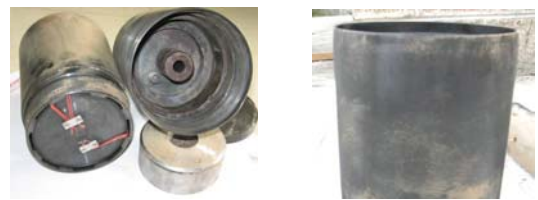
(a) 分离后的第2发试验件 (b) 分离舱壳体膨胀变形
