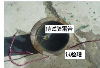
图3 浸入水中的待试验雷管
