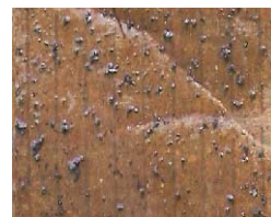
图4 爆炸后得到的膨胀石墨蠕虫
