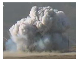
图3 可膨胀石墨烟弹静爆成烟效果
