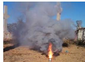
图2 EG发烟剂燃烧产生的烟幕状态
